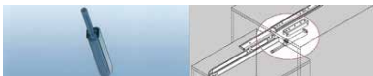
Softstopp demper voor Box geleider - indien de diepte > 700 mm of de breedte > 400 mm dan dient u 2 dempers te gebruiken
